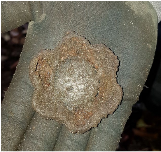
Fig. 3 – Tændsatsdæksel for Tellermine 42. Foto: Elsebeth Schønemann, 2019
