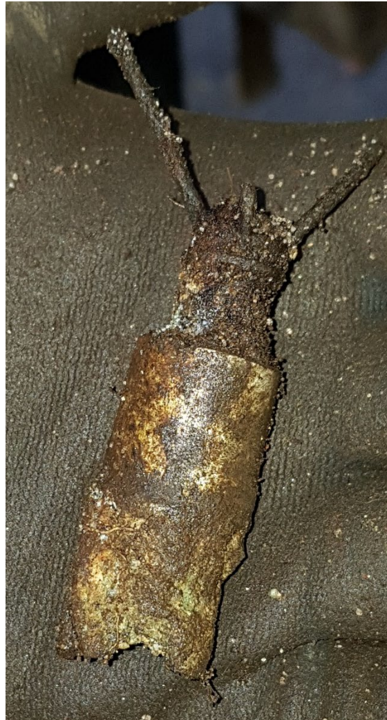
Fig. 4 – Del af tændsats til en S. Mine 35. Foto: Elsebeth Schønemann, 2019
